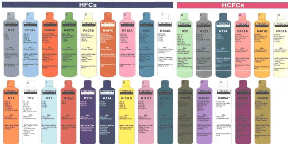
Hình A4-1: Mã màu cho hộp chứa môi chất lạnh
